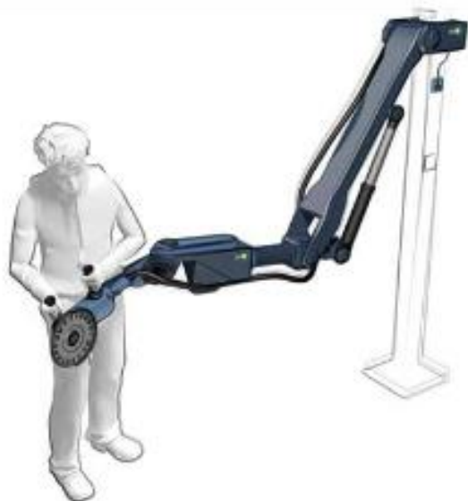
© Deledda Robot collaboratif d'assistance physique de type bras articulé (RAP sc)
