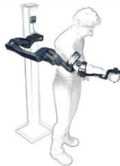
© Deledda Robot d'assistance des membres supérieurs de type bras exosquelette (RAP ac)
