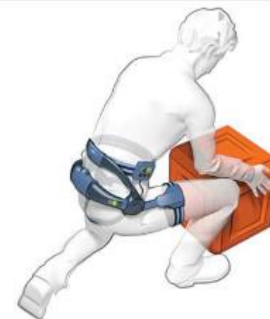
© Deledda Robot d'assistance du dos de type exosquelette (RAP ac)
